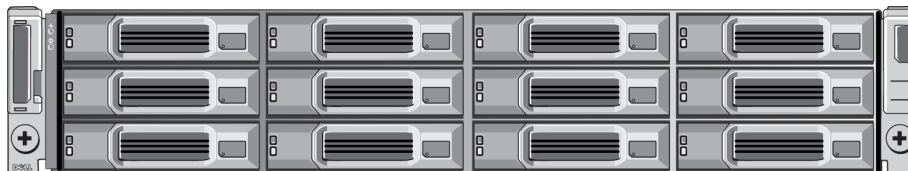
Abbildung 2: 3,5-Zoll-Laufwerkarray - Vorderansicht (ohne Blende)
