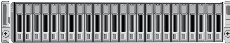
Şekil 3: 2,5 İnç Sürücü Dizisi - Önden Görünüm (Çerçevesiz)
