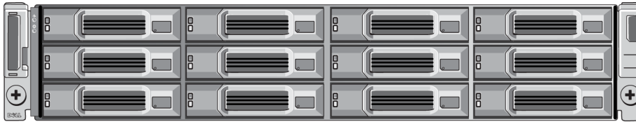
Şekil 2: 3,5 İnç Sürücü Dizisi - Önden Görünüm (Çerçevesiz)
