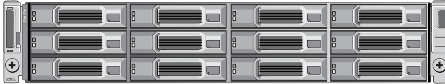
그림 2: 3.5인치 드라이브 배열 - 전면 모습 (베젤 미장착)
