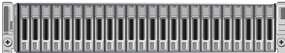
그림 3: 2.5인치 드라이브 배열 - 전면 모습 (베젤 미장착)
