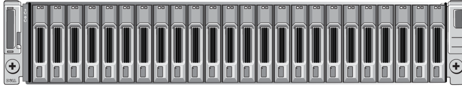
Ilustración 3: Arreglo de unidades de 2,5 pulgadas, vista frontal (sin bisel)
