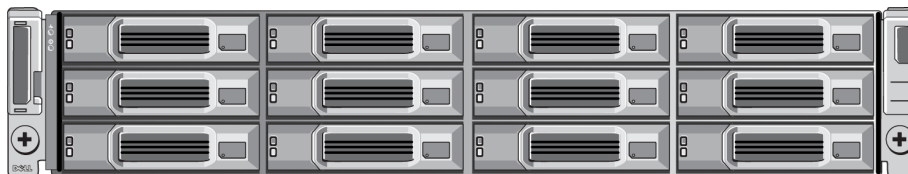
Ilustración 2: Arreglo de unidades de 3,5 pulgadas, vista frontal (sin bisel)
