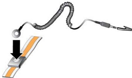
Рисунок 2-1: Использование антистатического браслета
