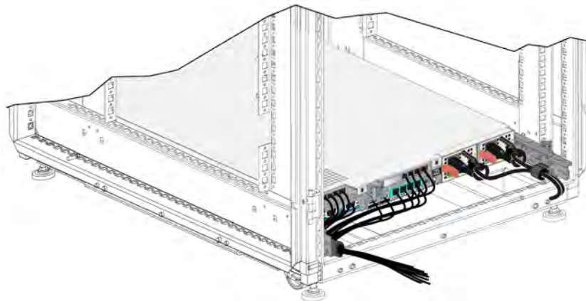
Figura 37: Cómo fijar los grupos de cables de alimentación y de señal
