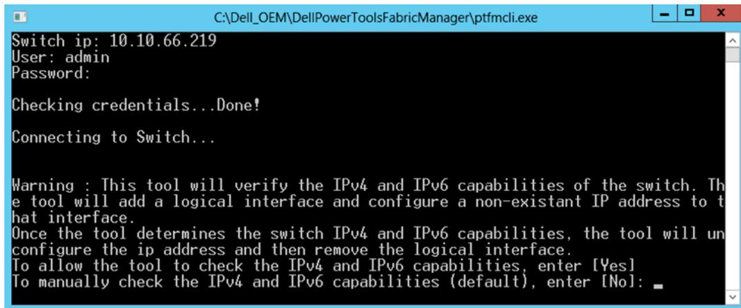
Figure 1 PowerTools Fabric Manager 连接至交换机 IP 地址时的初始屏幕。
