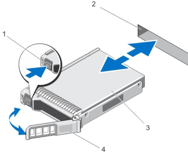
그림 4. 시스템에서 PCIe SSD 분리 및 설치
