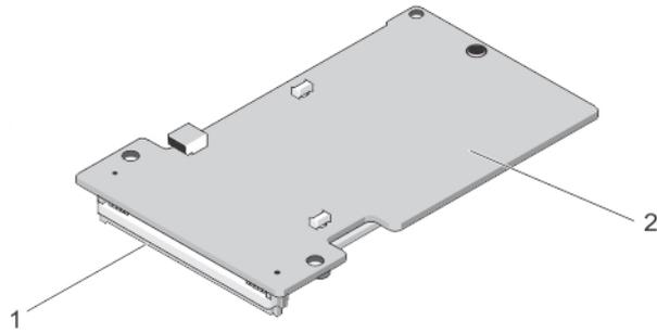
그림 2. PCIe SSD 모듈식 확장기 카드
