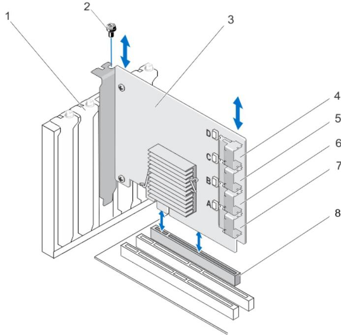
그림 5. PCIe 확장기 어댑터 카드 분리 및 설치
