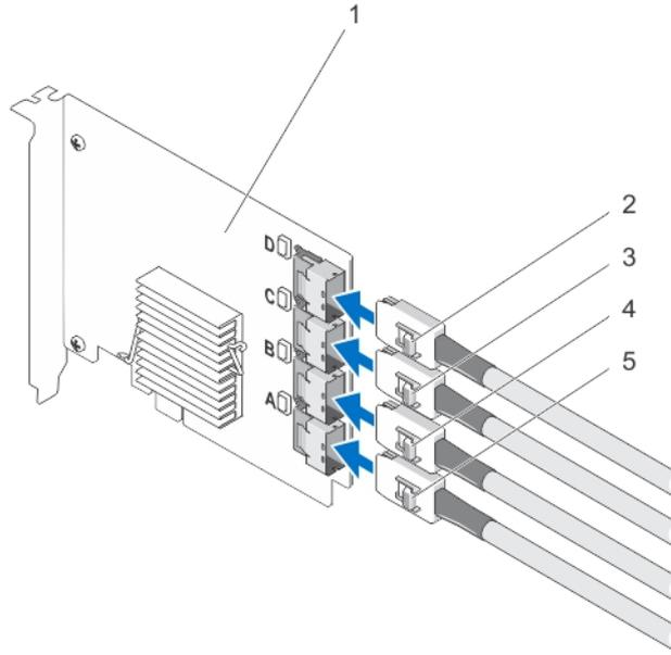
그림 6. PCIe 확장기 어댑터 카드 케이블 연결
