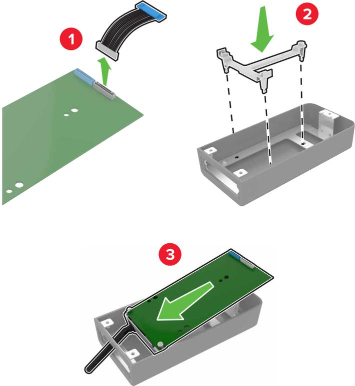
5 Instale el alojamiento en la cubierta de acceso de la placa del controlador.
