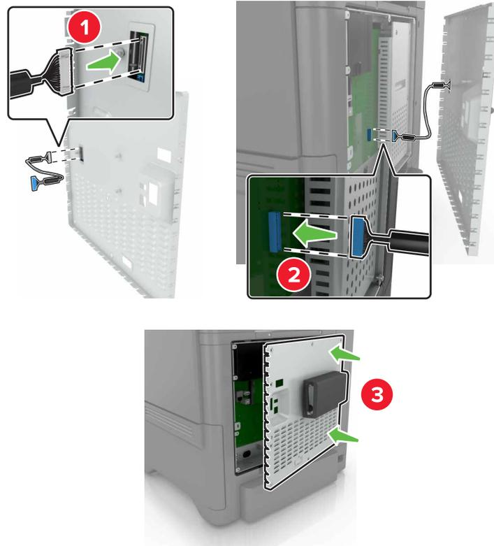
**7** Vuelva a instalar la cubierta de acceso a la placa del controlador.
