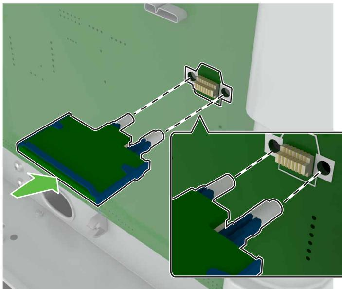
**Nota:** Todo el conector de la tarjeta debe tocar y estar nivelado con la placa del controlador.
