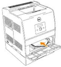
Legen Sie Briefumschläge mit einer Breite unter 8,66 Zoll (220 mm) mit geöffneter Umschlagklappe und der empfohlenen Druckseite nach oben so ein, dass die Kante mit der Umschlagklappe zur Vorderseite des Druckers zeigt.
