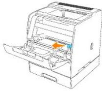
3. Führen Sie den Reinigungsstab einmal in den Drucker ein, und ziehen Sie ihn wieder heraus, um das Druckerinnere zu reinigen.
