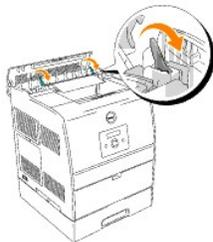
**HINWEIS** : Berühren Sie niemals die äußeren Hebel an beiden Seiten der Fixiereinheit, die zum Entfernen und Installieren der Fixiereinheit dienen.
