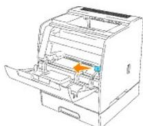
2. Öffnen Sie den Reinigungsstab heraus, bis das Reinigungskissen aus dem Drucker freikommt.
