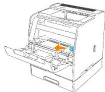
3. Führen Sie den Reinigungsstab einmal in den Drucker ein, und ziehen Sie ihn wieder heraus, um das Druckerinnere zu reinigen.
