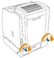
7. Entfernen Sie die Verbindungsabdeckung, und schließen Sie die Verbindung, die sich unten links an der optionalen Duplex-Modul befindet, an den Drucker an. Bewahren Sie die ursprüngliche Abdeckung sicher auf.
