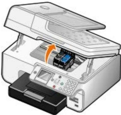
Le chariot des cartouches se place en position de chargement, sauf si l'imprimante est occupée.
