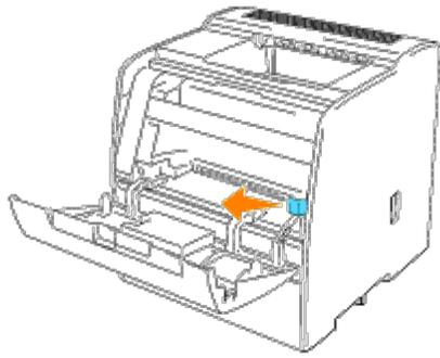
2. Öffnen Sie den Reinigungsstab heraus, bis das Reinigungskissen aus dem Drucker freikommt.
