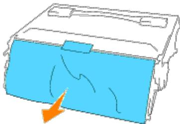
2. Zum Einsetzen der Trommelkassette Öffnen Sie den Hebel auf der rechten Seite nach oben. Bei senkrechtem Hebel halten Sie die Trommelkassette am Griff, richten Sie die Pfeile an der Kassette auf die entsprechenden Pfeile am Drucker aus, und schieben Sie die Kassette in den Drucker, bis sie hörbar einrastet.
