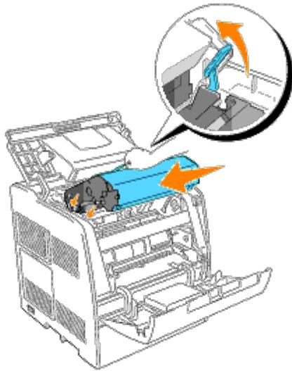
4. Ziehen Sie den Hebel auf der rechten Seite nach unten, um die Trommelkassette zu verriegeln.
