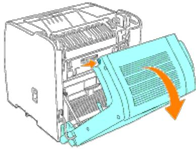
1. Zum Öffnen der beiden Abdeckungen am Drucker greifen Sie in die Aussparung der vorderen Abdeckung, und Öffnen Sie sie nach vorne. Klappen Sie die obere Abdeckung nach hinten auf.
