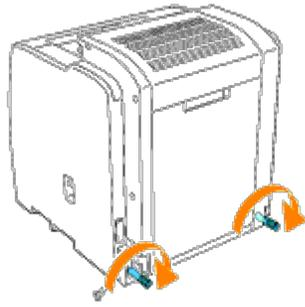
7. Entfernen Sie die Verbindungsabdeckung, und schließen Sie die Verbindung, die sich unten links an der optionalen Duplex-Modul befindet, an den Drucker an. Bewahren Sie die ursprüngliche Abdeckung sicher auf.
