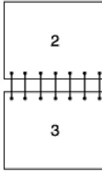
Kurze Kante Ausdrücke sollen an der kurzen Kante gebunden werden (obere Kante bei Druck im Hochformat und linke Kante bei Druck im Querformat). Die folgende Abbildung zeigt das Binden an der kurzen Kante beim Drucken im Hochformat und im Querformat:
