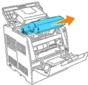
**⚠ ACHTUNG:** Fassen Sie nicht in den Drucker. Einige Komponenten können heiß werden. Lassen Sie den Drucker abkühlen, bevor Sie versuchen, Teile aus diesem Bereich zu entfernen.
