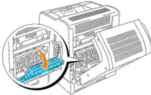
3. Entfernen Sie das Papier aus der Rückseite des Druckers. Wie das Papier zu entfernen ist, ergibt sich daraus, welcher Teil davon erreichbar ist. Wenn das Papier nicht erreichbar ist, fahren Sie mit Schritt 4 fort.
