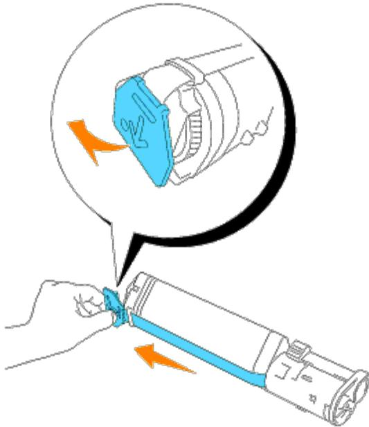
5. Zum Einsetzen der Tonerkassette richten Sie die Pfeile auf der Kassette auf die entsprechenden Pfeile am Drucker aus. Schieben Sie die Kassette in den Drucker, bis sie einrastet, und drücken Sie dann den Handgriff nach unten, um die Kassette zu arretieren.
