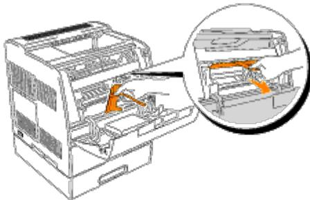
3. Vergewissern Sie sich, dass die Farbe der Tonerkassette mit der Tonerkassettenöffnung an der Tonerkassettenhalterung übereinstimmt. Die Reihenfolge ist Y, M, C, K. Schütteln Sie die Kassette vorsichtig, um den Toner gleichmäßig zu verteilen.
