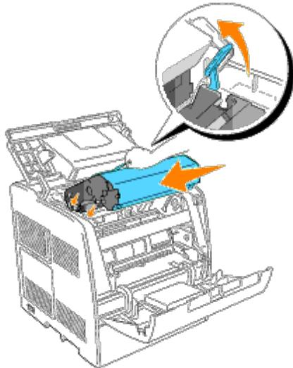
6. Ziehen Sie den Hebel auf der rechten Seite nach unten, um die Trommelkassette zu verriegeln.
