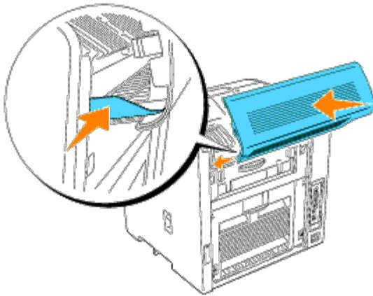
9. Öffnen Sie die innere hintere Abdeckung. Bringen Sie die Abdeckung, die Sie seit der Installation der Duplexeinheit aufbewahrt haben, so an, dass sie hörbar einrastet, und schließen Sie dann die hintere Abdeckung.
