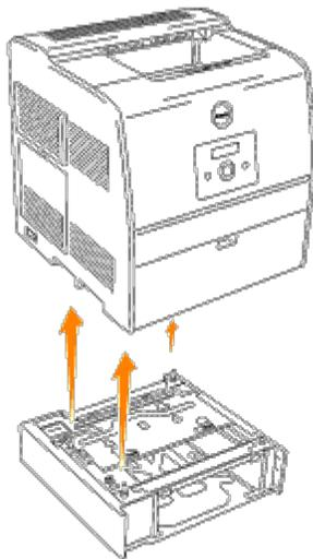
6. Befestigen Sie die Papierfacheinheiten aneinander, indem Sie die soeben entfernte bzw. zusätzliche Papierfacheinheit oben aufsetzen und die beiden mitgelieferten Schrauben einsetzen. Ziehen Sie die Schrauben mit einer Münze fest an.
