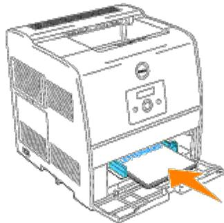
4. Schieben Sie die Seitenführungen so an den Druckmedienstapel, dass sie die Seite des Stapels leicht berühren.
