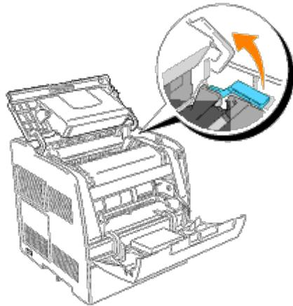
3. Fassen Sie die Trommelkassette am Griff an, und Öffnen Sie sie nach oben heraus.
