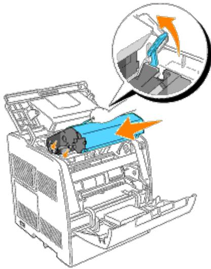
3. Ziehen Sie den Hebel auf der rechten Seite nach unten, um die Trommelkassette zu verriegeln.
