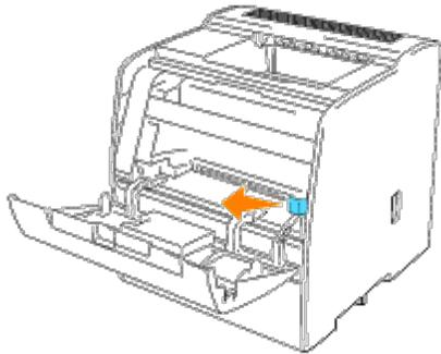
3. Führen Sie den Reinigungsstab einmal in den Drucker ein, und ziehen Sie ihn wieder heraus, um das Druckerinnere zu reinigen.
