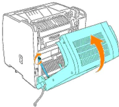
6. Halten Sie die optionale Duplexeinheit fest in der geschlossenen Stellung, und ziehen Sie die Schrauben unten links und rechts an.
