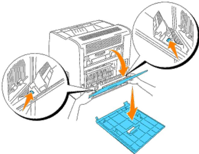
3. Zum Entfernen der Papierabdeckung, drücken Sie die Papierabdeckung nach innen, und ziehen Sie gleichzeitig die rechte Seite der Druckerabdeckung heraus.
