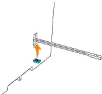
5. Schieben Sie den Reinigungsstab wieder bis zum Anschlag in seine ursprüngliche Stellung zurück.
