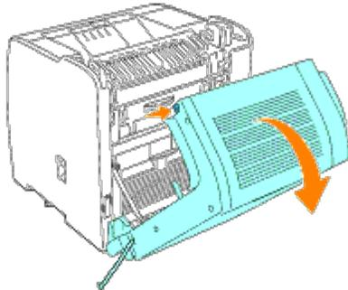
6. Lösen Sie die Befestigungsschrauben der Bänder links und rechts an der optionalen Duplex-Modul.
