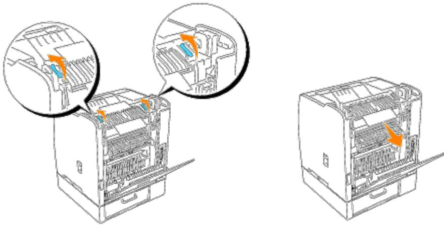
**HINWEIS:** Berühren Sie niemals die äußeren Hebel an beiden Seiten der Fixiereinheit, die zum Entfernen und Installieren der Fixiereinheit dienen.
