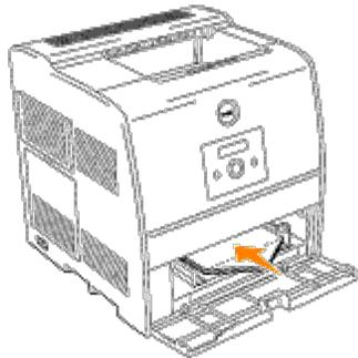
Legen Sie Briefumschläge mit einer Breite unter 8,66 Zoll (220 mm) mit geöffneter Umschlagklappe und der empfohlenen Druckseite nach oben so ein, dass die Kante mit der Umschlagklappe zur Vorderseite des Druckers zeigt.
