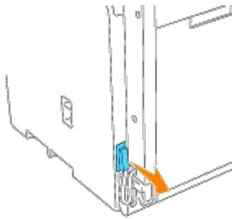
2. Lösen Sie die Verbindung unten links an der Duplex-Modul. Setzen Sie dann die ursprüngliche Verbindungsabdeckung in die Verbindung ein.
