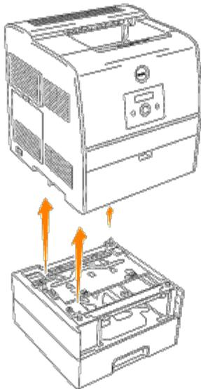
4. Zum Entfernen der Papierfächer, lockern Sie die Schrauben mit einer Münze, und entfernen Sie sie aus dem Inneren des Papierfachs.
