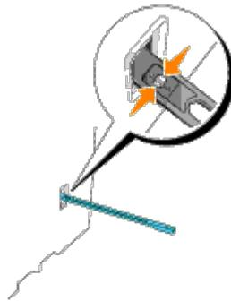
4. Halten Sie das neue Reinigungskissen unter den Reinigungsstab und drücken Sie es ein, bis es einrastet.
