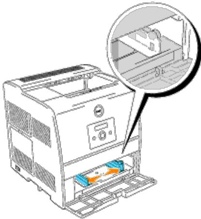
3. Legen Sie die Druckmedien mit der empfohlenen Druckseite nach oben in das Fach ein.
