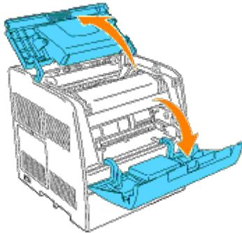
2. Zum Entnehmen der verbrauchten Trommelkassette drücken Sie den Hebel auf der rechten Seite nach oben.
