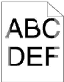
· Stellen Sie sicher, dass die Tonerkassette richtig eingesetzt ist.
