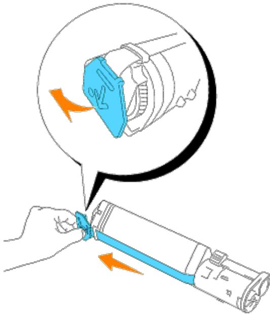
6. Halten Sie die Tonerkassette zum Einsetzen so, dass die Pfeile auf der Kassette auf die entsprechenden Pfeile am Drucker ausgerichtet sind. Schieben Sie die Kassette in den Drucker, bis sie einrastet, und drücken Sie dann den Handgriff nach unten, um die Kassette zu arretieren.
