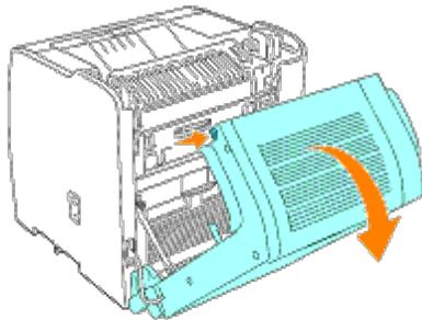
1. Zum Öffnen der beiden Abdeckungen am Drucker greifen Sie in die Aussparung der vorderen Abdeckung, und Öffnen Sie sie nach vorne. Klappen Sie die obere Abdeckung nach hinten auf.
