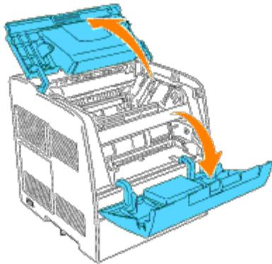
2. Entfernen Sie den Transportschutz von der Trommelkassette.
