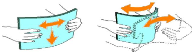
5. Legen Sie die Druckmedien mit der empfohlenen Druckseite nach oben in das Fach ein.
