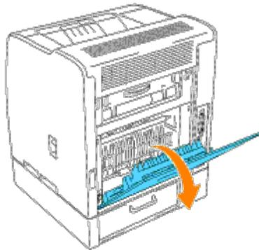
2. Entfernen Sie das Papier aus der Rückseite des Druckers. Wie das Papier zu entfernen ist, ergibt sich daraus, welcher Teil davon erreichbar ist. Wenn das Papier nicht erreichbar ist, fahren Sie mit Schritt 3 fort.
