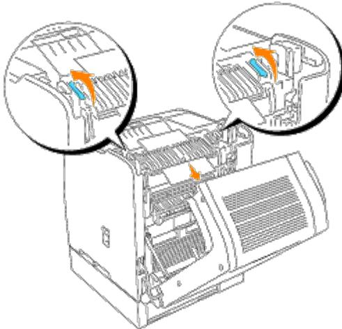
**✎ HINWEIS:** Berühren Sie niemals die äußeren Hebel an beiden Seiten der Fixiereinheit, die zum Entfernen und Installieren der Fixiereinheit dienen.
