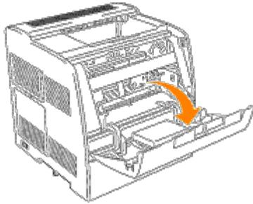
2. Ziehen Sie das Klebeband an der Schutzabdeckung nach vorne, und entfernen Sie die Abdeckung von jeder Tonerkassettenöffnung.
