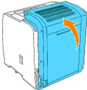
9. Bringen Sie die neue Verbindungsabdeckung, die mit der Duplex-Modul geliefert wurde, an.
