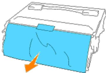
3. Zum Einsetzen der Trommelkassette ziehen Sie den Hebel auf der rechten Seite nach oben. Bei senkrechtem Hebel halten Sie die Trommelkassette am Griff, richten Sie die Pfeile an der Kassette auf die entsprechenden Pfeile am Drucker aus, und schieben Sie die Kassette in den Drucker, bis sie hörbar einrastet.
