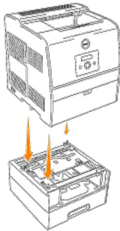
8. Befestigen Sie die Papierfacheinheit(en) aneinander, indem Sie das Papierfach aus der oberen Papierfacheinheit entfernen und den Verriegelungsmechanismus wie in der Abbildung dargestellt drehen.
