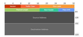
Figure 55. IPv6 Header Fields
