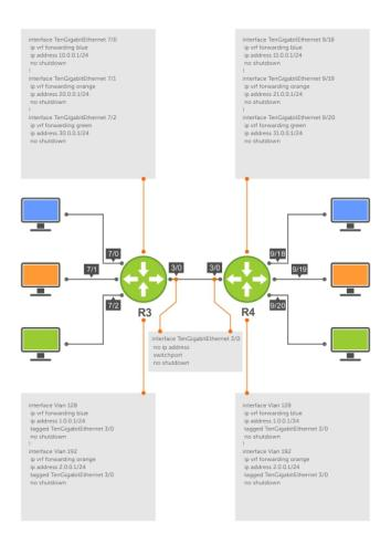
Figure 169. Setup VRF Interfaces
