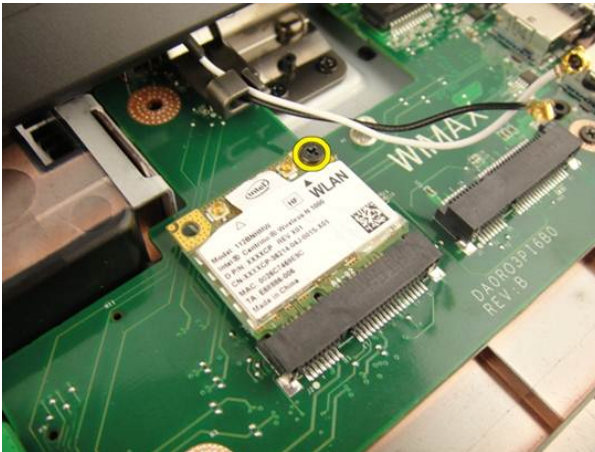
10. ดึงการ์ด WLAN ออกจากซ็อกเก็ตตรง ๆ จากนั้นนำออก
