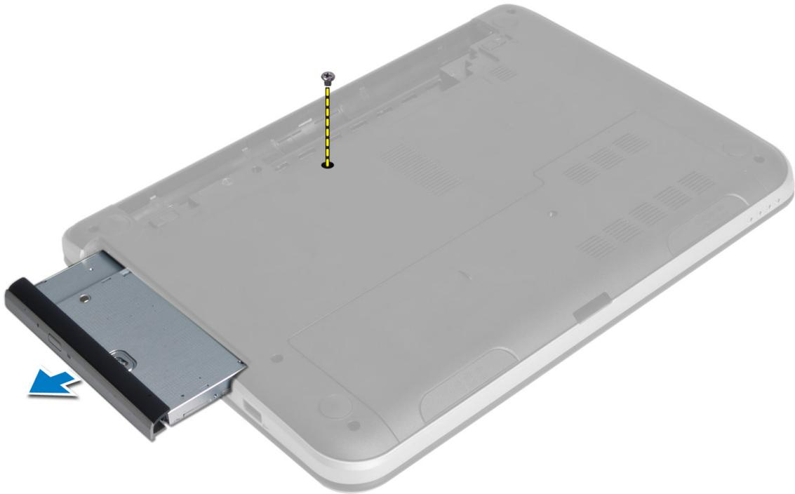
4. 卸下將光碟機托架固定在光碟機組件上的螺絲。
