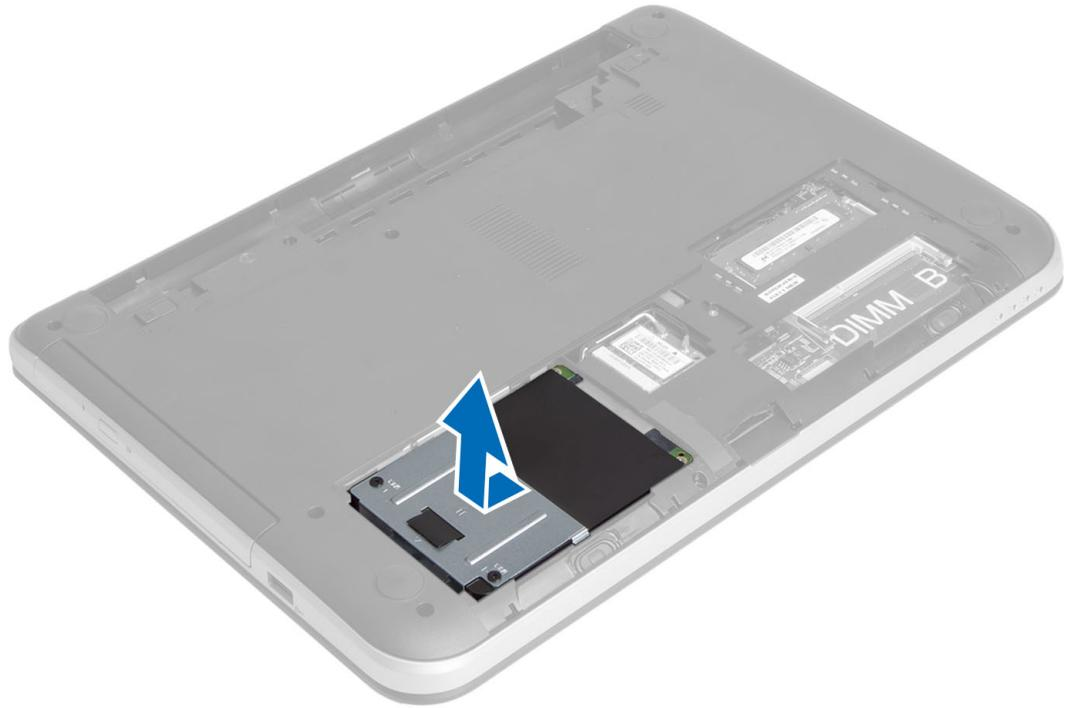
5. 卸下用來將硬碟機貯存盒固定至硬碟機的螺絲。
