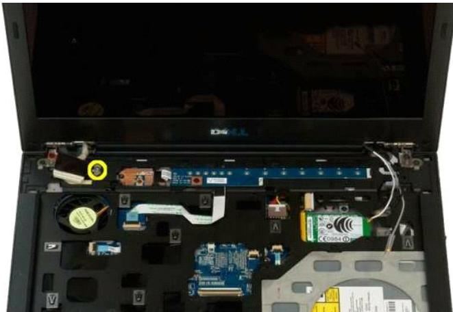
11. 卸下將顯示幕組件固定到電腦基座的四顆螺絲。
