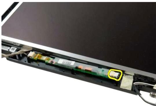
6. 從顯示幕組件中拔下反相器資料纜線。
