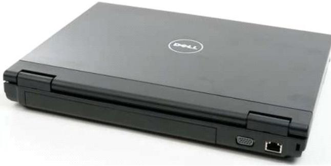
3. 使用塑料筆輕輕將鉸接護蓋的後側從電腦底座撬起。
