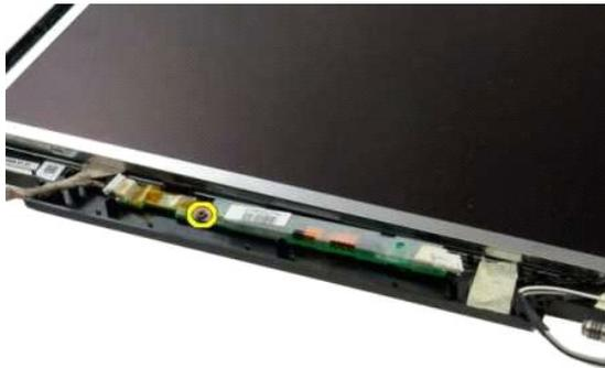
5. 從顯示幕組件中拔下反相器電源線。
