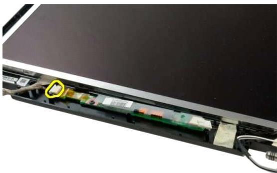
7. 將顯示幕反相器從顯示幕組件中卸下。
