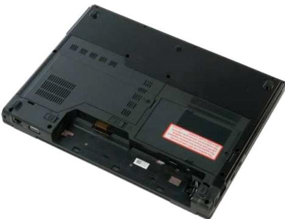
3. 卸下將硬碟機蓋板固定至電腦底部的緊固螺絲。
