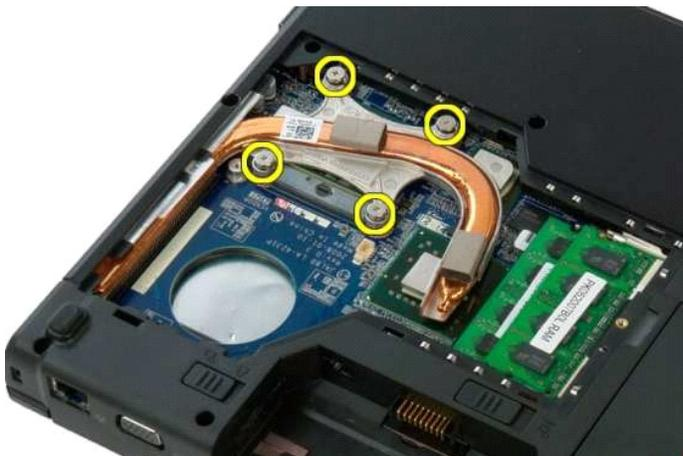
6. 提起散熱器靠近電腦中心部分的邊緣。
