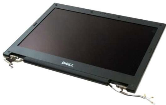
3. 從顯示幕前蓋卸下六顆橡膠螺絲蓋。
