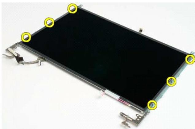
7. 將鉸接元件從顯示板組件滑出。
