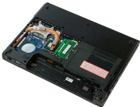
5. 擰鬆用來將散熱器固定至電腦的四顆緊固螺絲。
