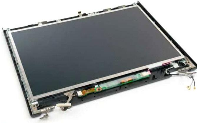
4. 卸下將 LCD 顯示板固定到顯示幕組件的兩顆螺絲。
