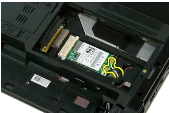
5. 卸下將 WLAN 卡固定至主機板的螺絲。
