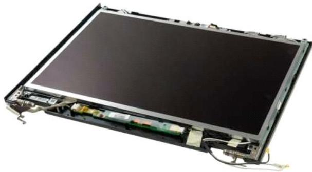
4. 卸下將顯示幕反相器固定到顯示幕組件的螺絲。
