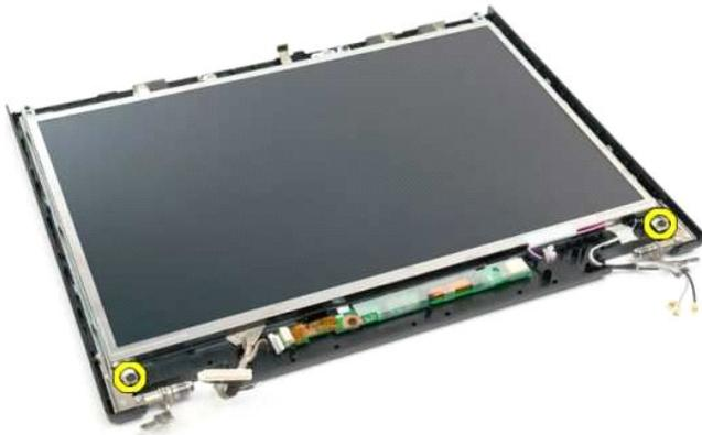
5. 從顯示幕組件上拔下電源線。
