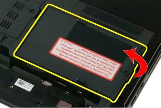
5. 從電腦中卸下硬碟機蓋板。
