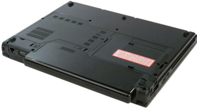
2. 將位於左側的電池鎖定門鎖從電池滑出。
