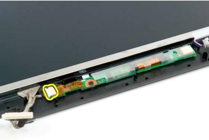
7. 將 LCD 顯示板從顯示幕組件中卸下。
