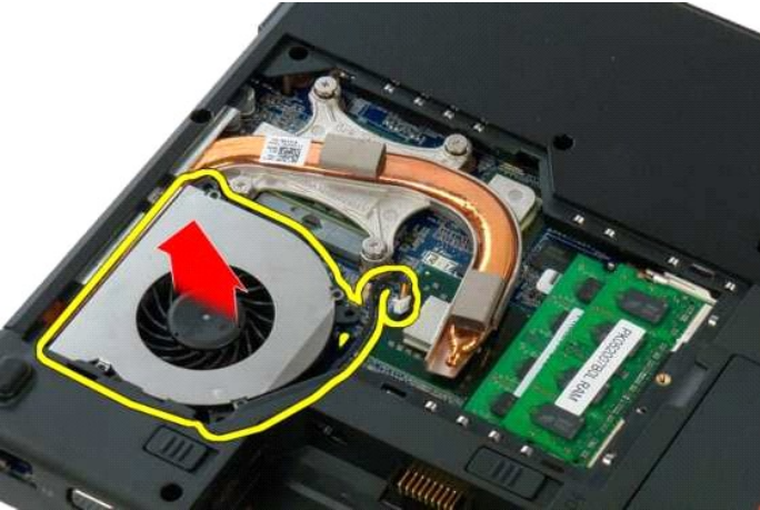
6. Til de ventilator uit de computer.
