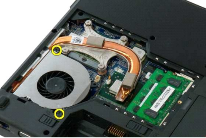
6. Til de ventilator uit de computer.
