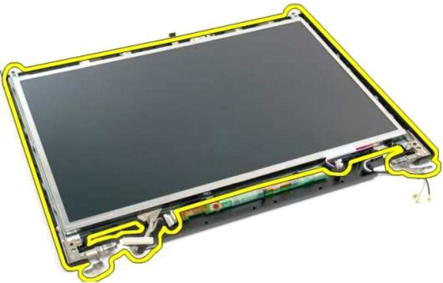
7. Verwijder het LCD-beeldschermpaneel uit het beeldscherm.
