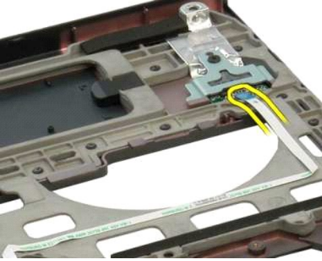
13. Verwijder de schroef waarmee de beugel van de vingerafdruklezer aan het computerchassis is bevestigd.
