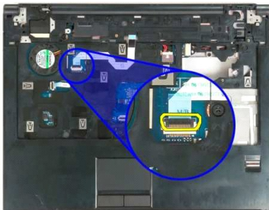
15. マルチメディアボタンボードのデータケーブルをクリップから外します。
