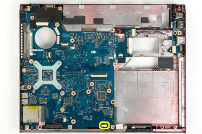
19. Kobl USB-kortets datakabel fra systemkortet.
