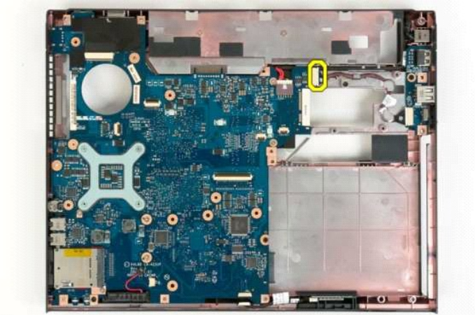
20. Fjern strømforsyningskablet fra systemkortet.
