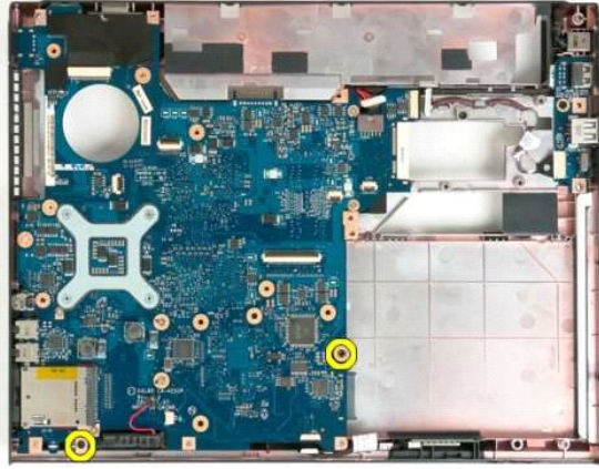
22. قم بإزالة لوحة النظام من هيكل الكمبيوتر.
