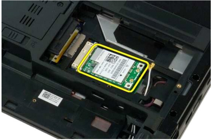
6. قم بإزالة بطاقة WLAN من الكمبيوتر.
