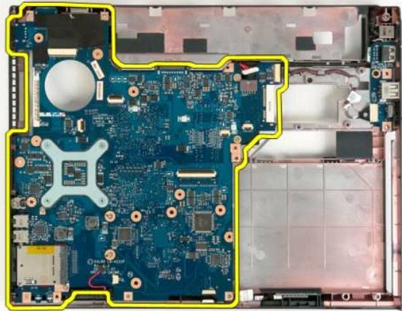
22. قم بإزالة لوحة النظام من هيكل الكمبيوتر.
