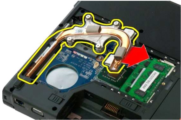
8. باستخدام محرك أقراص صلبة بمسامير لولبية مسطحة الرأس، قم بتدوير كامة المعالج عكس عقارب الساعة.
