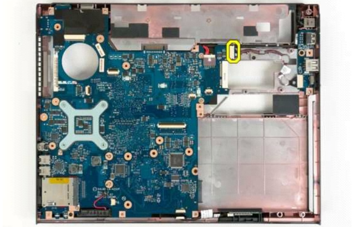
02. فصل كابل الطاقة عن لوحة النظام.
