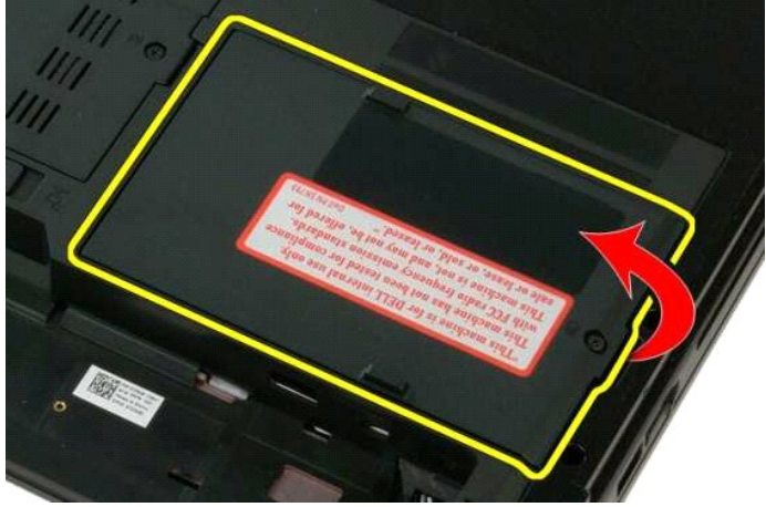
5. قم بإزالة لوحة الوصول إلى محرك القرص الصلب من الكمبيوتر.
