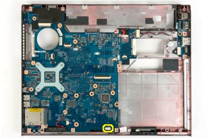
91. فصل كابل بيانات لوحة USB من لوحة النظام.
