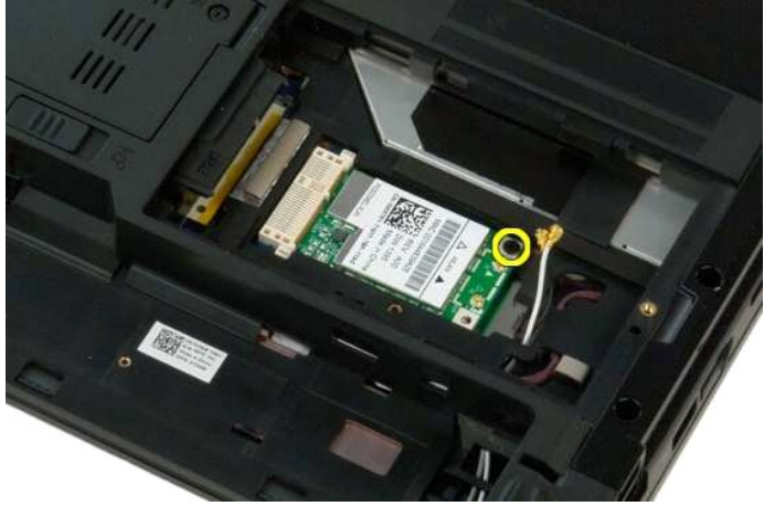
6. قم بإزالة بطاقة WLAN من الكمبيوتر.
