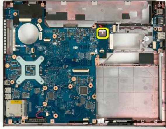
12. قم بترك المسامير اللولبية اللذان يعملان على إحكام تثبيت لوحة النظام بهيكل الكمبيوتر.
