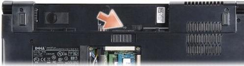
3. Drehen Sie den Computer mit der Oberseite nach oben und öffnen Sie den Bildschirm so weit, wie es geht.
