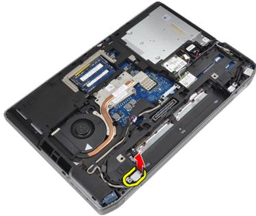
6. 電源コネクタケーブルをコンピュータから外します。
