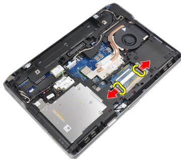
4. メモリモジュールをシステム基板上のコネクタから取り外します。
