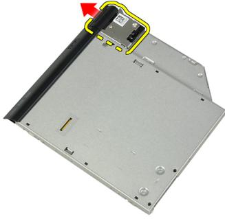
7. オプティカルドライブラッチブラケットをオプティカルドライブアセンブリに固定しているネジを外します。
