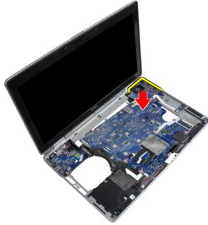
14. システム基板を持ち上げて、コンピュータから取り出します。
