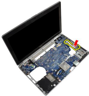
12. システム基板の端を 45 度の角度に持ち上げます。
