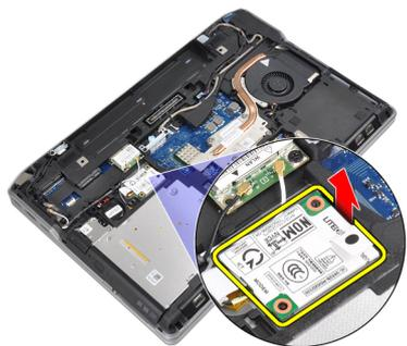
5. モデムカードからモデムケーブルを取り外します。
