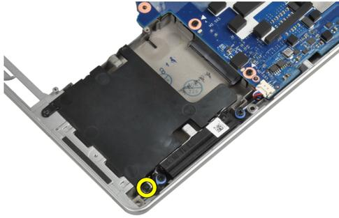
4. ハードドライブサポートプレートを持ち上げてコンピュータから取り出します。
