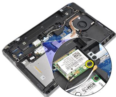
5. WLAN カードをシステム基板上のスロットから取り外します。
