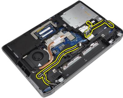
8. ネジを外して両側のディスプレイアセンブリを取り外します。
