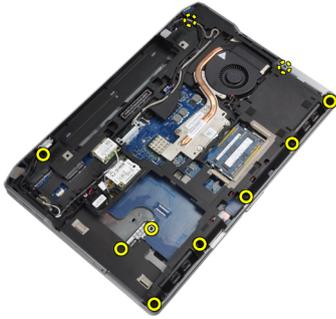
4. コンピュータを裏返し、パームレストアセンブリをコンピュータに固定しているネジを外します。
