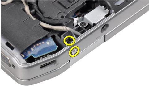
9. ディスプレイアセンブリを持ち上げ、LVDS ケーブルとアンテナケーブルをコンピュータの開口部から引き出します。
