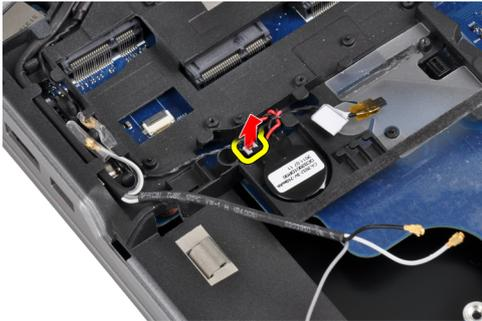
9. スピーカーケーブルをシステム基板の上端から外します。
