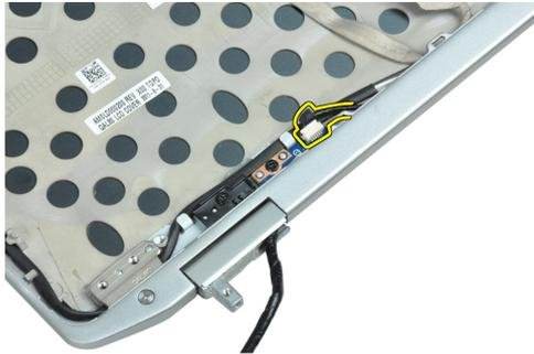
4. 電源 LED ボードをディスプレイアセンブリに固定しているネジを外します。
