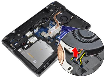
4. ヒートシンクをシステム基板に固定しているネジを外します。
