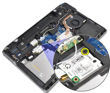
4. モデムカードを持ち上げて、カードのコンネクタからタブを外します。
