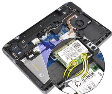
4. WLAN カードをコンピュータに固定しているネジを外します。
