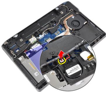
4. コイン型バッテリーを外してコンピュータから取り出します。
