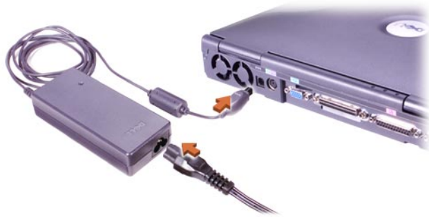
รูปที่ 6-2. การเชื่อมต่ออะแดปเตอร์ AC
