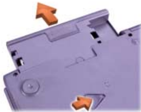
Figure 2-8. Retrait d'une batterie de la baie de batterie
