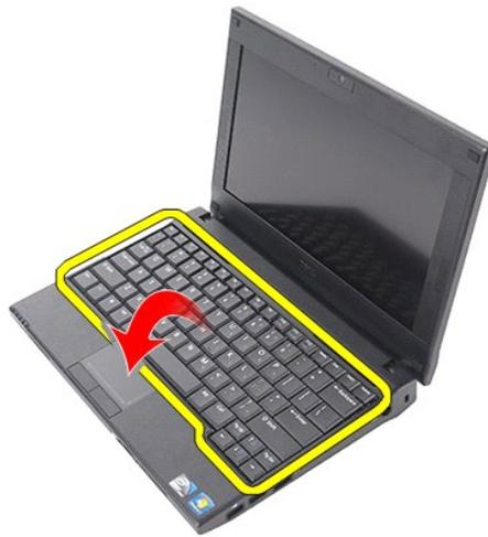
6. Débranchez le câble de données du clavier et retirez le clavier de l'ordinateur.
