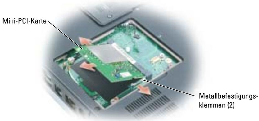
➔ **HINWEIS:** Diese Schnittstellenanschlüsse sind passgeformt, um korrektes Einstecken zu gewährleisten. Wenn Sie beim Einstecken auf Widerstand stoßen, prüfen Sie die Anschlüsse und richten Sie die Karte neu aus.
