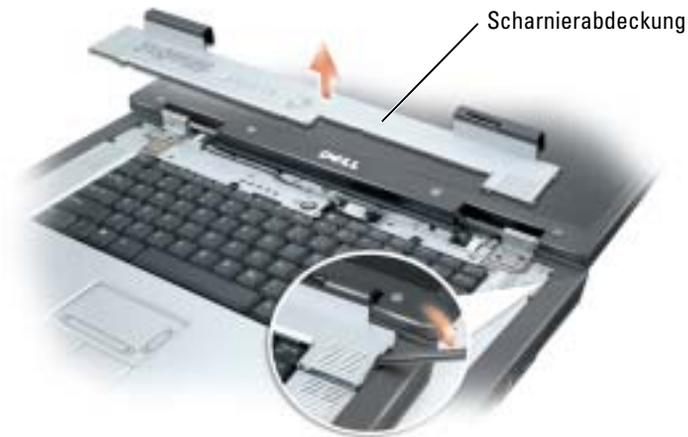
Wenn Sie die Scharnierabdeckung auswechseln, setzen Sie sie zuerst an der linken Ecke ein und drücken Sie dann von links nach rechts, bis die Abdeckung einrastet.
