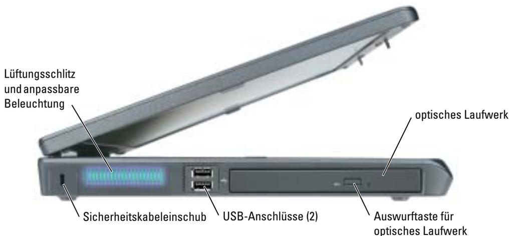
**OPTISCHES LAUFWERK** – Der Einbauschaft dient zur Aufnahme von DVD- oder anderen optischen Laufwerken. Weitere Informationen finden Sie unter „Optisches Laufwerk“ auf Seite 101.
