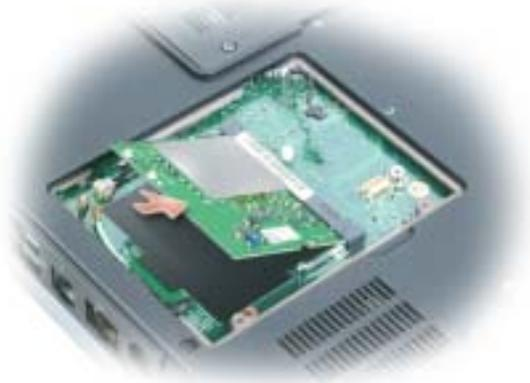
➔ **HINWEIS:** Um eine Beschädigung der Mini-PCI-Karte zu vermeiden, sollten Sie das Kabel nie unter der Karte platzieren.
