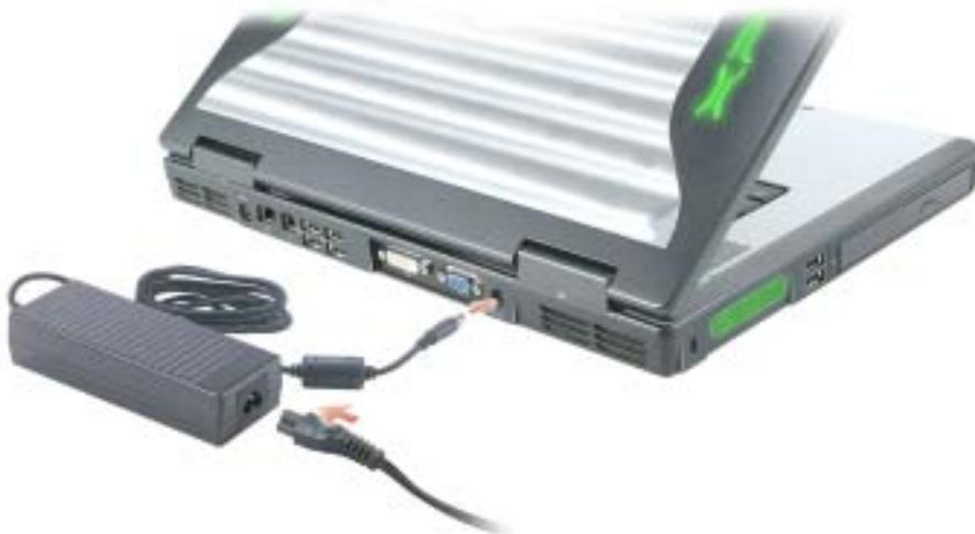
Der Netzadapter wandelt Wechselstrom in den vom Computer benötigten Gleichstrom um. Sie können den Netzadapter bei ein- oder ausgeschaltetem Computer anschließen.
