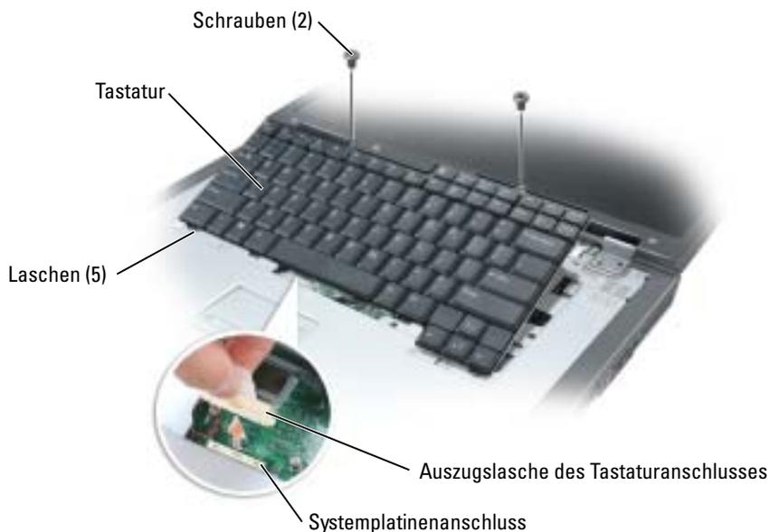
**HINWEIS:** Um ein Zerkratzen der Handballenstütze beim Einsetzen der Tastatur zu vermeiden, hängen Sie zunächst die fünf Laschen an der vorderen Kante der Tastatur in die Handballenstütze ein und bringen die Tastatur anschließend in die endgültige Einbauposition.
