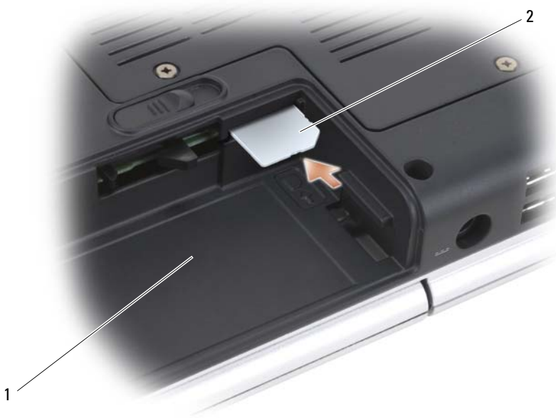
1 baie de batterie 2 SIM
