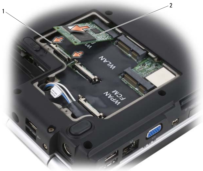
1 languettes de fixation en métal (2) 2 FCM
