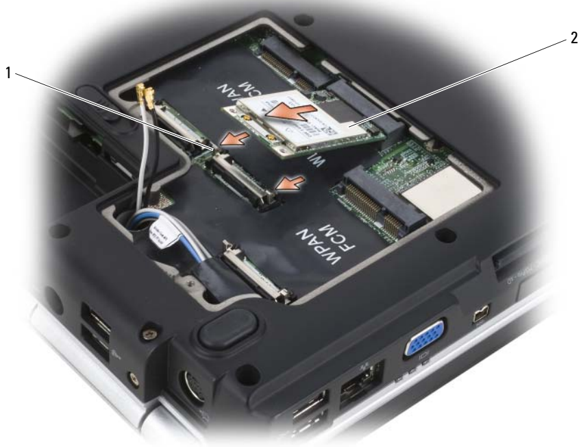
1 languettes de fixation en métal (2) 2 carte WLAN
