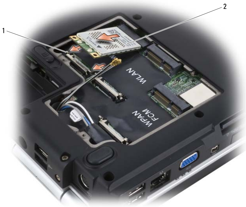
1 languettes de fixation en métal (2) 2 carte WWAN
