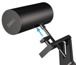
3. 打開網路攝影機固定架底座，將網路攝影機固定架連同網路攝影機夾在顯示器的邊框上。
