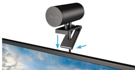
4. Прижмите основание кронштейна веб-камеры к задней крышке монитора, чтобы надежно закрепить камеру.
