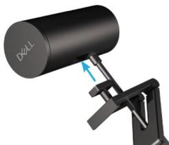
3. Раскройте основание кронштейна веб-камеры и закрепите кронштейн вместе с веб-камерой на рамке монитора.
