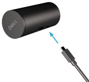
3. Alinhe e insira a cabeça do adaptador de tripé na abertura de suporte da webcam na webcam.
