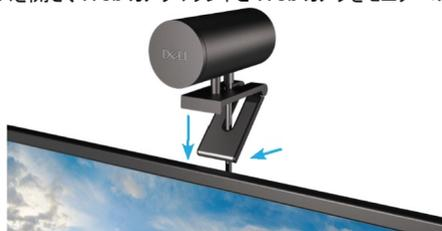
4. Web カメラ マウントのベースをモニターの背面カバーに向けて押し、Web カメラをしっかりと取り付けてください。
