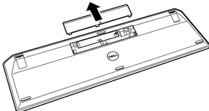
2. Inserte las baterías AAA en su compartimento. A continuación vuelva a colocar la tapa de la batería.
