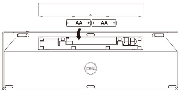
3. Установите крышку батарейного отсека на место.
