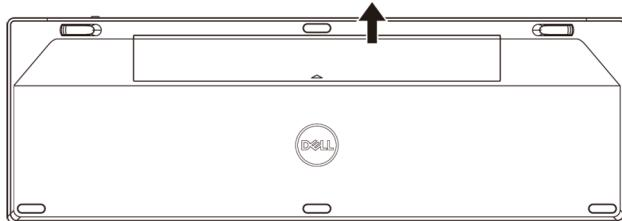
2. Установите батарейки типоразмера AA в батарейный отсек.
