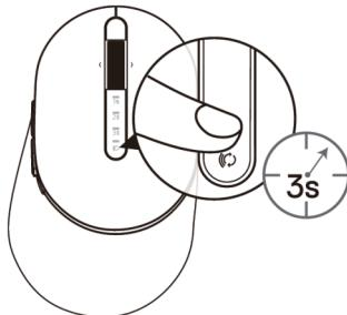
2. Индикатор режима подключения (2 $\circ$ ) мигает в течение 3 минут, указывая на то, что мышь находится в режиме сопряжения.
