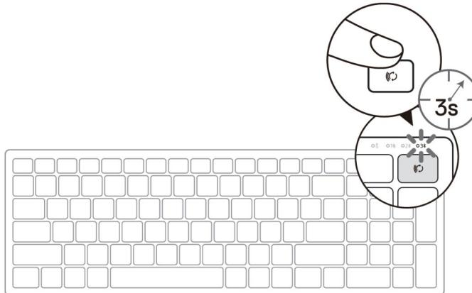
2. Выполните сопряжение клавиатуры с компьютером, на котором включен Bluetooth.
