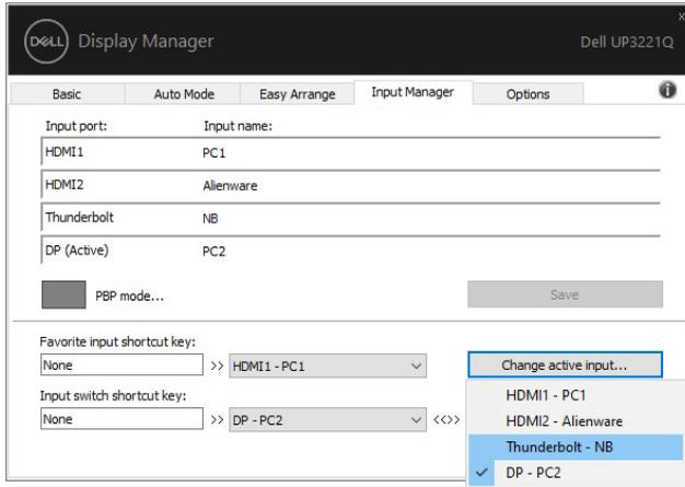
**ПРИМЕЧАНИЕ:** Программа DDM обменивается сигналами с вашим монитором, даже когда он отображает видео с другого компьютера. Вы можете установить программу DDM на тот ПК, который часто используете, и с него управлять переключением входов. Вы можете также установить программу DDM на другие ПК, подключенные к монитору.
