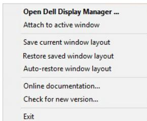
Для возврата к избранному варианту компоновки сначала выберите **"Save current window layout" (Сохранить текущую компоновку окон)**, а затем **"Restore saved window layout" (Восстановить сохраненную компоновку окон)**.
