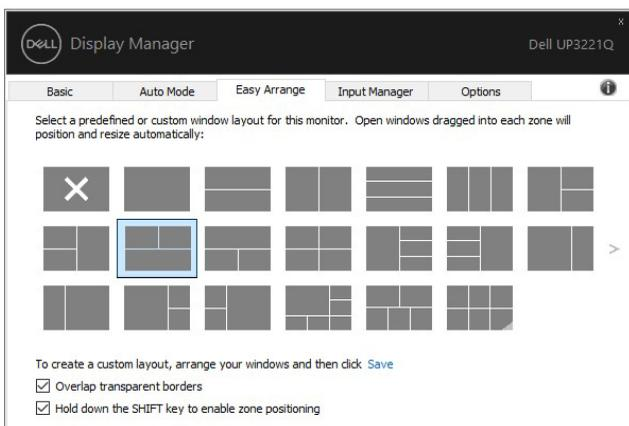
При использовании нескольких мониторов в массиве или матрице функцию компоновки **Easy Arrange (Простая компоновка)** можно применить ко всем мониторам как к одному рабочему столу. Для включения этой функции выберите **"Span multiple monitors" (Расширение на нескольких мониторах)**. Для правильного использования нужно выровнять мониторы.
