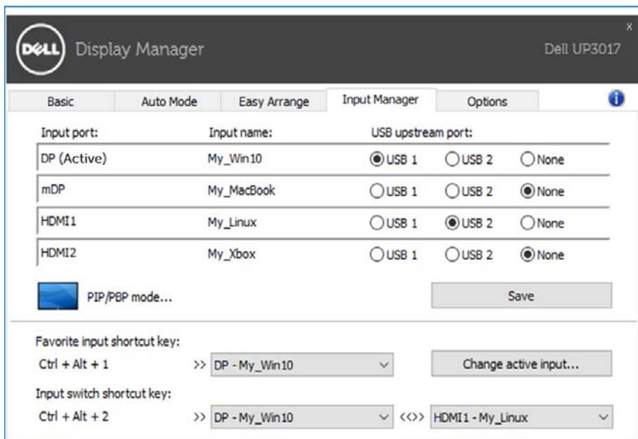
Můžete přepnout na libovolný vstup pomocí rozevíracího seznamu.
