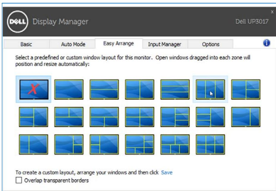
Chcete-li vytvořit vlastní rozvržení oken, nejdříve na pracovní ploše upravte velikost a polohu oken (max. 10) a potom klepněte na odkaz **Uložit** v části **Easy Arrange**. Velikost a pozice oken se uloží jako vlastní rozvržení a je vytvořena odpovídající ikona.
