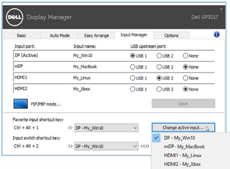
**POZNÁMKA:** DDM komunikuje s vaším monitorem, i když monitor zobrazuje video z jiného počítače. Můžete nainstalovat DDM do počítače, který často používáte, a přepínat z něho vstupy. DDM můžete rovněž nainstalovat do jiných počítačů, které jsou připojené k monitoru.
