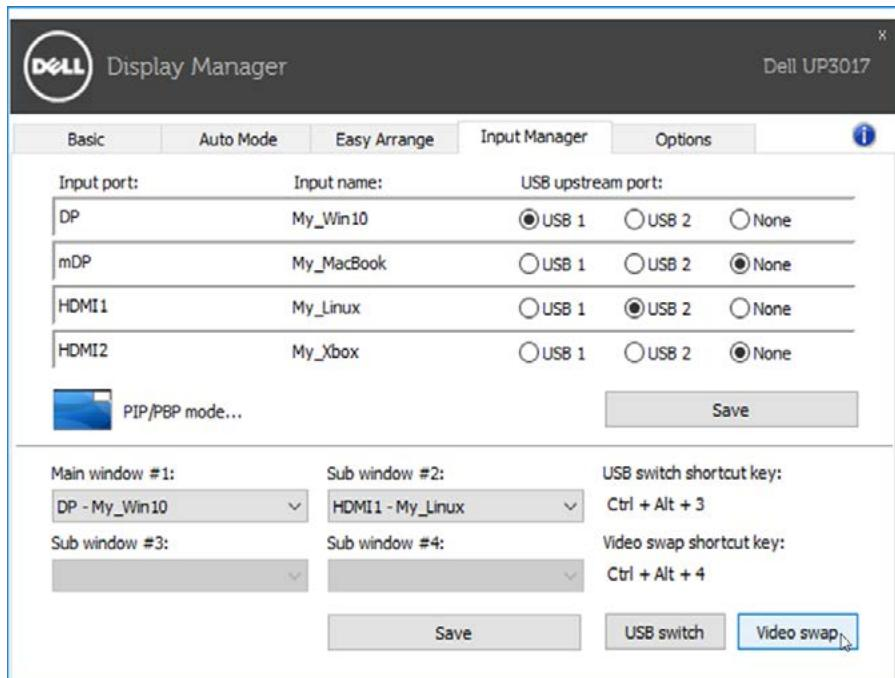
Можете да зададете USB upstream порт с входен видеосигнал. Назначеният USB upstream порт ще бъде свързан към компютъра, когато на монитора се показва видео.
