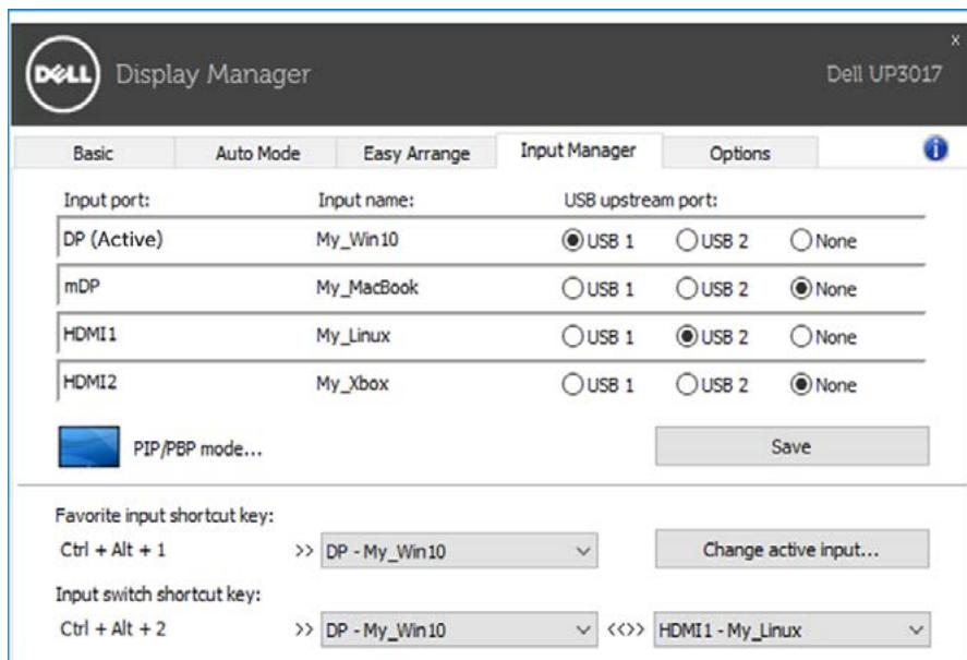
Можете да използвате падащия списък за превключване на произволен източник на входен сигнал.
