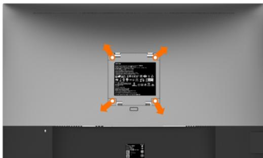
**NOTA:** Utilizzare viti M4 x 10 mm per collegare il monitor al kit di montaggio a parete.
