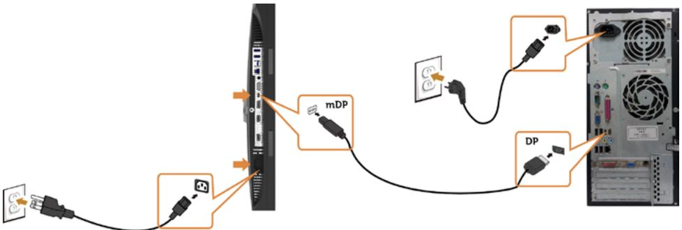
**📎 NOTA:** el puerto por defecto es DP. Seleccione una fuente de entrada en el monitor para cambiar a mDP.
