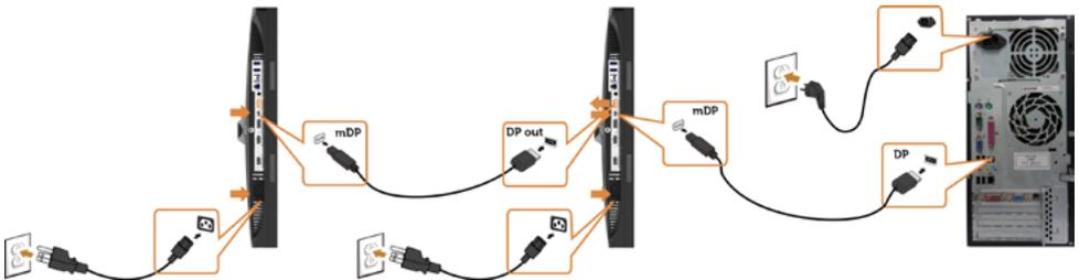
**NOTA:** El dispositivo admite la función DP MST. Para utilizar esta función, la tarjeta gráfica de su equipo debe contar con la certificación para utilizar DP1.2 con la opción MST.
