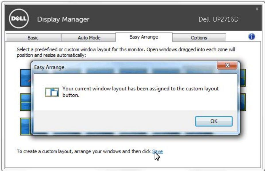
Zur Nutzung des gespeicherten benutzerdefinierten Layouts wählen Sie dessen Symbol. Zum Löschen des gespeicherten benutzerdefinierten Layouts schließen Sie sämtliche Fenster auf dem Desktop und klicken anschließend in Easy Arrange auf **Speichern**.
