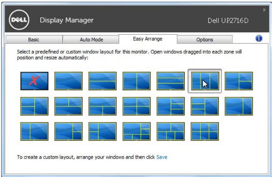
Passen Sie zur Erstellung eines nutzerdefinierten Fensterlayout Größe und Position der Fenster (maximal 10) am Desktop an, klicken Sie dann auf die Speichern-Verknüpfung bei Easy Arrange. Größe und Position der Fenster werden als benutzerdefiniertes Layout gespeichert, zusätzlich wird ein Symbol dazu angelegt.
