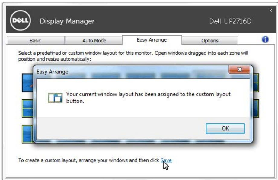
Aktuálně uložené rozvržení vyvoláte klepnutím na ikonu vlastního rozvržení. Aktuálně uložené vlastní rozvržení odstraníte tak, že zavřete všechna okna na pracovní ploše a pak klepnete na Uložit v Easy Arrange.
