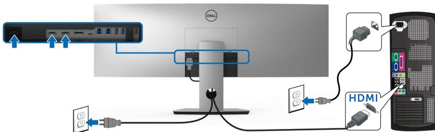
**NOTA:** L'impostazione di fabbrica predefinita in U4919DW è HDMI 2.0. Se il monitor non mostra alcun contenuto quando viene collegato il cavo HDMI, seguire le procedure di seguito per cambiare le impostazioni da HDMI 2.0 a HDMI 1.4:
