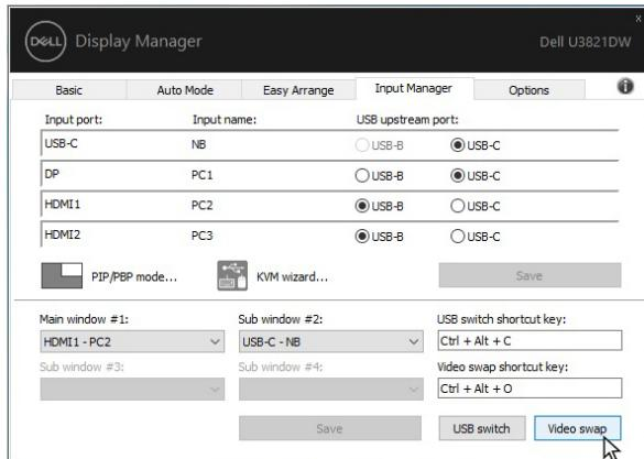
Вы можете назначить USB-разъем восходящей передачи для нужного видеовхода. Этот назначенный USB-разъем восходящей передачи будет подключаться к компьютеру, когда видео с него отображается на мониторе.
