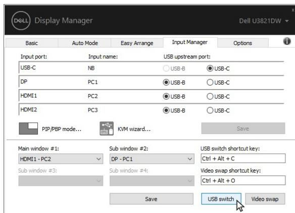
**ПРИМЕЧАНИЕ:** Обязательно назначьте USB-разъем восходящей передачи для каждого из двух компьютеров.
