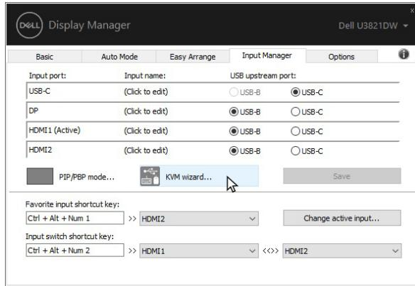
**ПРИМЕЧАНИЕ:** Обязательно назначьте USB-разъем восходящей передачи для каждого из подключенных устройств.
