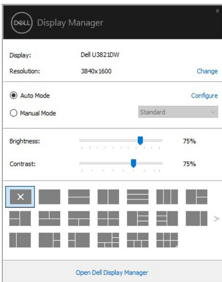
Диалоговият прозорец **Бързи настройки** също така дава достъп до разширения потребителски интерфейс на Dell Display Manager, който се използва за основни функции, конфигуриране на автоматичен режим и достъп до други функции.
