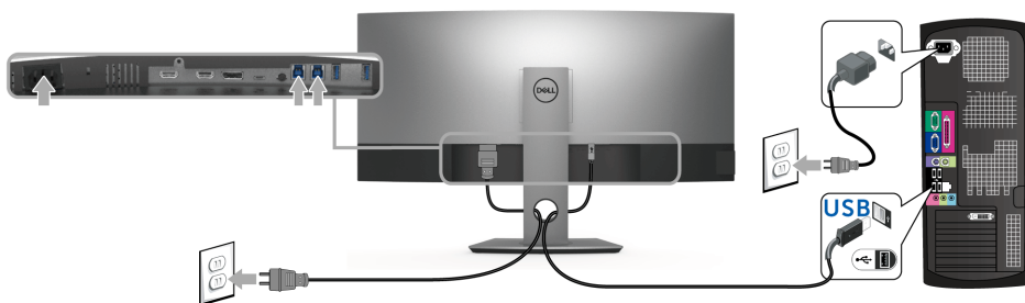
a. Pripojenie jedného počítača
