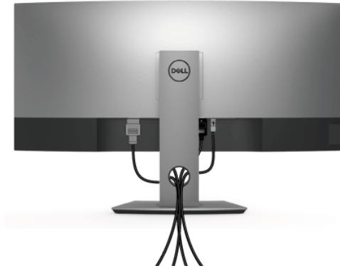
Setelah memasang semua kabel yang diperlukan ke monitor dan komputer, (Lihat [Menyambungkan Monitor](#) untuk pemasangan kabel,) atur semua kabel seperti ditunjukkan di bawah ini.
