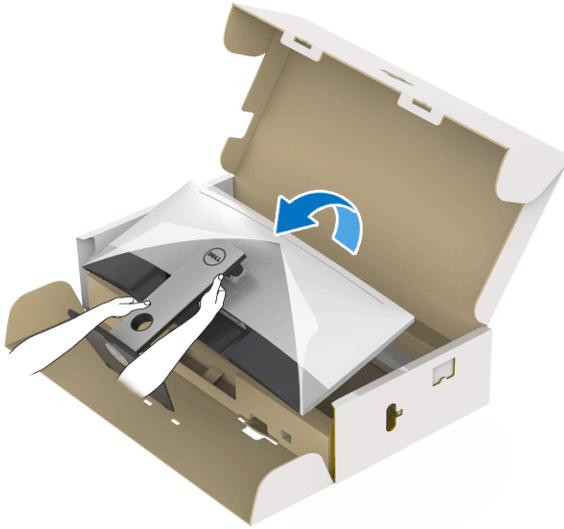
8. Retire la cubierta del monitor.
