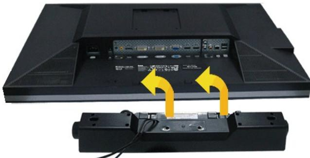
1. Lavorando nella parte posteriore del monitor, fissare la barra audio allineando le due aperture della barra audio con i due denti nella parte posteriore del monitor.
