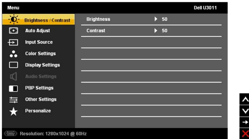
**NOTA:** L'opzione AUTO ADJUST (Regolazione automatica) è disponibile solo quando si usa il connettore analogico (VGA).
