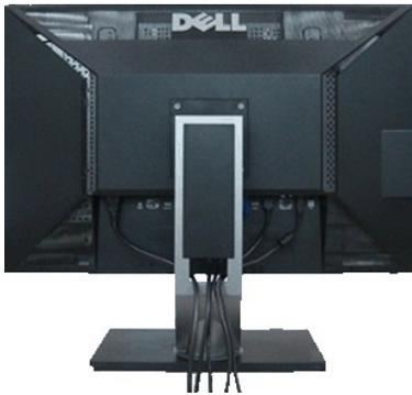
Dopo aver fissato tutti i cavi al monitor e al computer, (Si veda [Collegamento del Monitor](#) per i collegamenti dei cavi,) usare il passacavi per organizzare i cavi in maniera ordinata, come mostrato sopra.
