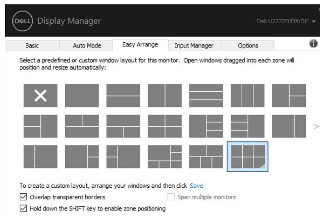
Ukoliko koristite više monitora u nizu ili matrici, **Easy Arrange (Jednostavno uređivanje)** prikaz može da se primeni na sve monitore kao jedna radna površina. Odaberite “**Span multiple monitors**” (**Obuhvati višestruke monitore**) da omogućite ovu funkciju. Treba da poravnate svoje monitore korektno da bi ovo bilo efikasno.
