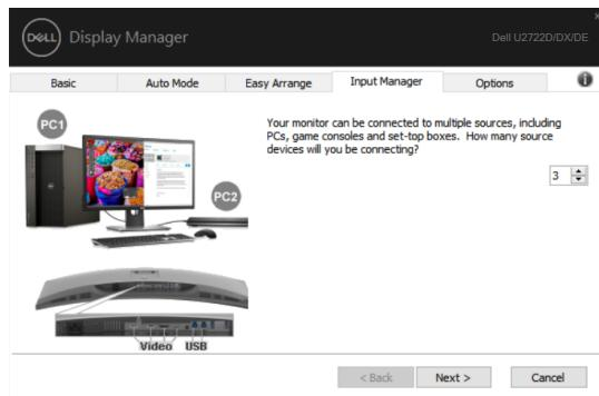
Kod PC1-PC3, izaberite Video Input Port (Port video ulaza) za povezivanje s portom i izaberite USB Upstream Port za povezivanje s portom, a zatim pritisnite NEXT (DALJE).
