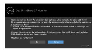
• Wenn Sie OSD-Elemente von Display Reset (Display-Rücksetzung) unter Display-Funktion wählen, erscheint folgende Meldung:
