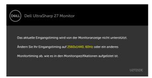
Das bedeutet, dass sich der Monitor mit dem vom Computer empfangenen Signal nicht synchronisieren kann. Siehe Technische Daten des Monitors für die horizontalen und vertikalen Frequenzbereiche, die für diesen Monitor adressierbar sind. Empfohlener Modus ist 1920 x 1080(U2421HE) / 2560 x 1440 (U2721DE).
