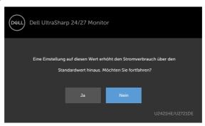
Wenn USB-C Charging (USB-C-Laden) auf On During Power Off (Aus während Ausschalten) geschaltet ist und USB-C Prioritization (USB-C-Priorisierung) auf High Data Speed (Hohe Datengeschwindigkeit) geschaltet ist und Sie OSD-Elemente von Factory Reset (Werksrücksetzung) unter Other (Sonstiges) wählen, erscheint folgende Meldung:
